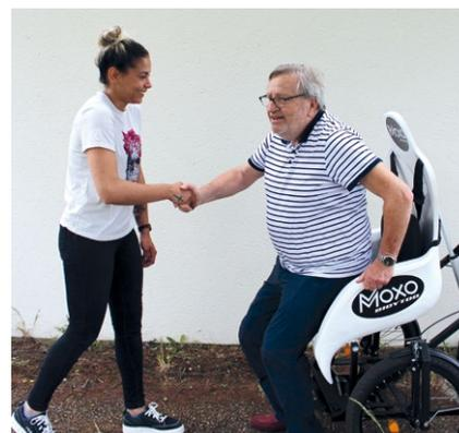
À la demande des ergothérapeutes, nous avons créé un système d'inclinaison du siège avec le vérin électrique. Cela permet au siège de s'incliner à 25°. Le but est de faciliter les transferts du passager. Cette inclinaison est un confort pour le passager et pour l'accompagnant. Elle permet de lutter contre le mal de dos ainsi que les TMS des accompagnants et des soignants.
